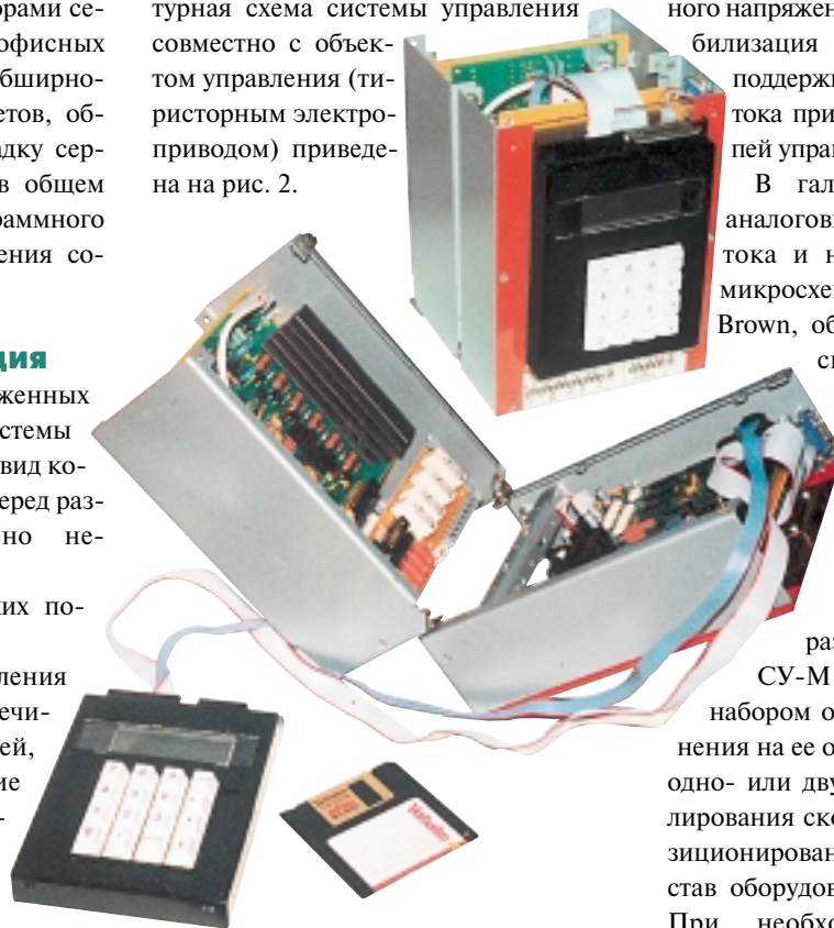
Рис. 1. Внешний вид и внутренняя компоновка СУ-М1
