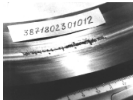
Рис. 1г. Вид поврежденной беговой дорожки наружной обоймы роликоподшипника. Максимальная стадия (нездолго до разрушения): повреждена вся поверхность беговой дорожки
