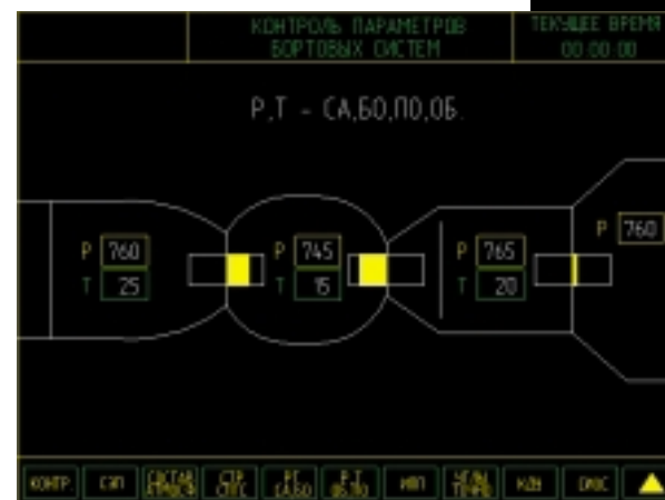
Рис. 4. Отображение давления в отсеках при решении задачи перехода из корабля на станцию
