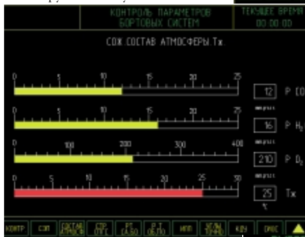
Рис. 3. Отображение аналоговых параметров
