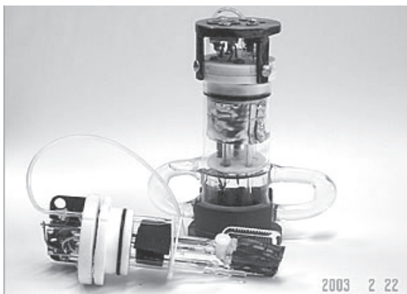
Электролитический реактор для холодного синтеза профессора Эдмонда Стормза
