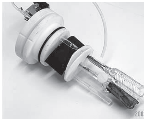
Палладиевый реактор. На фото показана разобранная камера реактора холодного синтеза, включая анод и палладиевый катод
