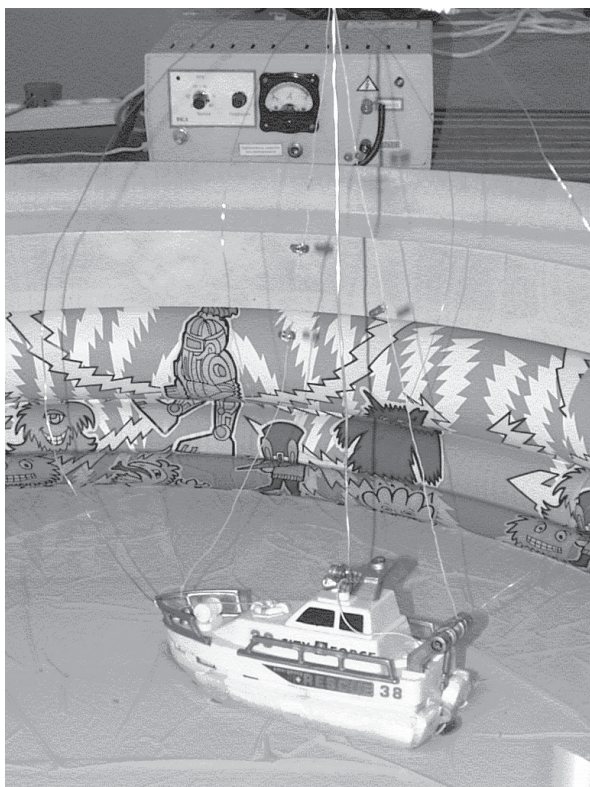
Рис. 10. Испытания макета электрического речного судна в лаборатории ВИЭСХ с использованием водопроводной воды в качестве однопроводникового волновода. Передающий блок имеет электрическую мощность 100 Вт, напряжение 1 кВ.
