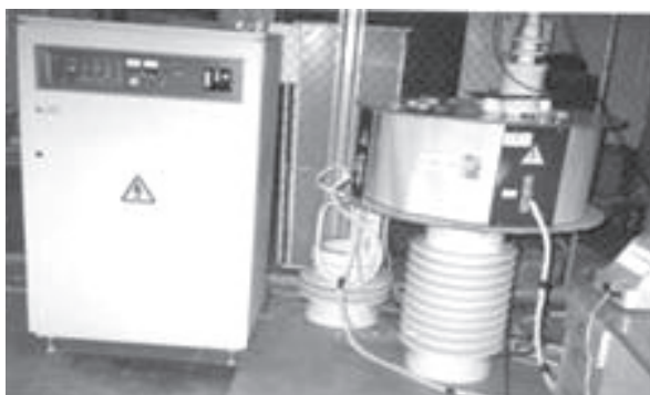
Рис. 9. Преобразователь частоты и резонансный контур передающего высокочастотного трансформатора электрической мощностью 20 кВт, 10 кВ
